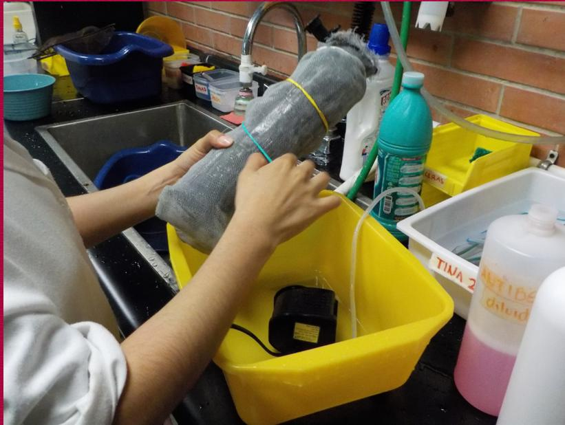
El filtro es muy potente, por lo que puede llegar a absorber pequeños charales. Para reducir este efecto, el filtro se encuentra cubierto con dos mallas que dejan libre solo la salida de aire, la manguera y la maquinaria. La primera malla se encuentra sujeta al filtro con ligas; para asegurar la sujeción, se le coloca una liga a cada uno de los segmentos. La segunda malla cubre la primera y está sujeta sólo de la parte superior, justo debajo de la maquinaria.
